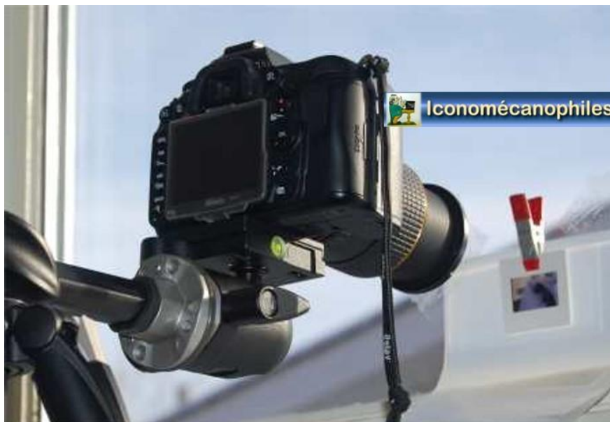
Installation pour photographier des diapositives
