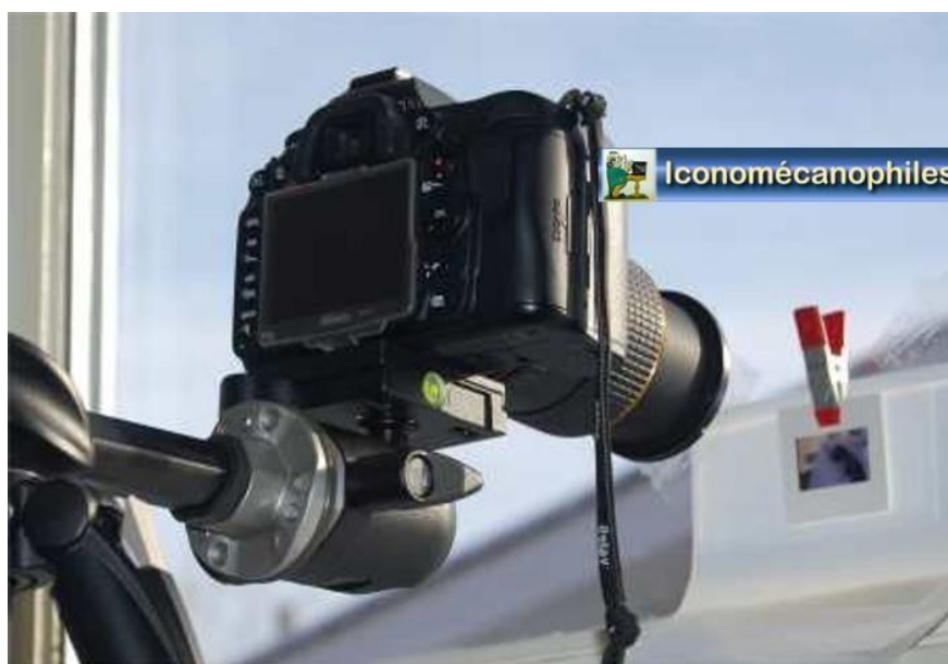
Installation pour photographier des diapositives
