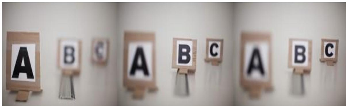
J'ai placé A, B et C à des distances équivalentes (il y a 60 cm entre A et C). J'ai successivement fait la mise au point sur A, B puis C, et on voit bien que lorsqu'A est net, C, est très flou (ouverture : 1.4).
